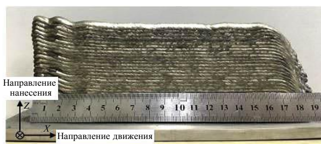
Рис. 2. Внешний вид тонкой стенки из магниевого сплава AZ31, наплавленной с помощью процесса холодного переноса металла (WAAM–CMT)
