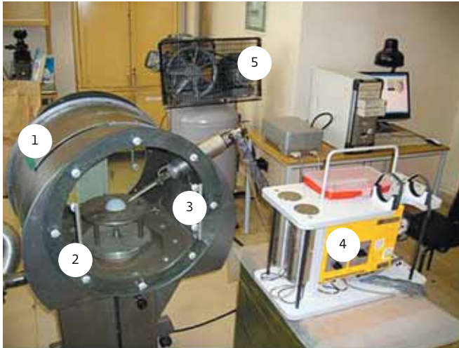
Рис.1. Полуавтоматическая установка нанесения покрытий методом ХГН: 1 – камера; 2 – манипулятор с образцами; 3 – сверхзвуковое сопло; 4 – порошок питатель; 5 – компрессор
