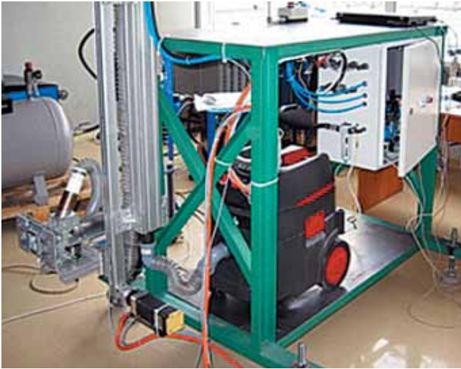
Рис.2. Роботизированная установка нанесения покрытий методом ХГН
