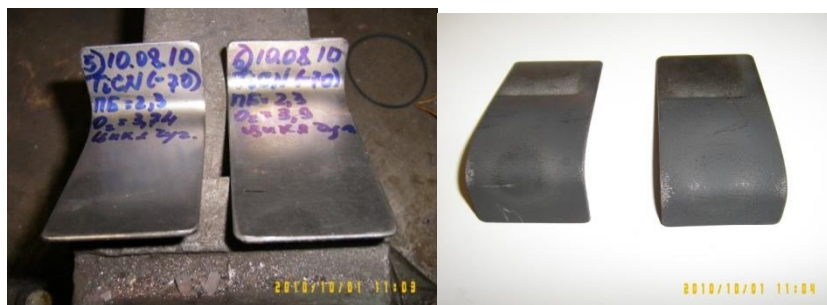
Рис. 11. Стальные пластины с покрытием, изогнутые на прямой угол
