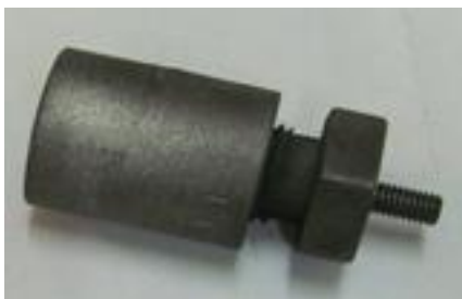
Рис. 3. Фотография штифтового образца в сборе, перед испытанием
