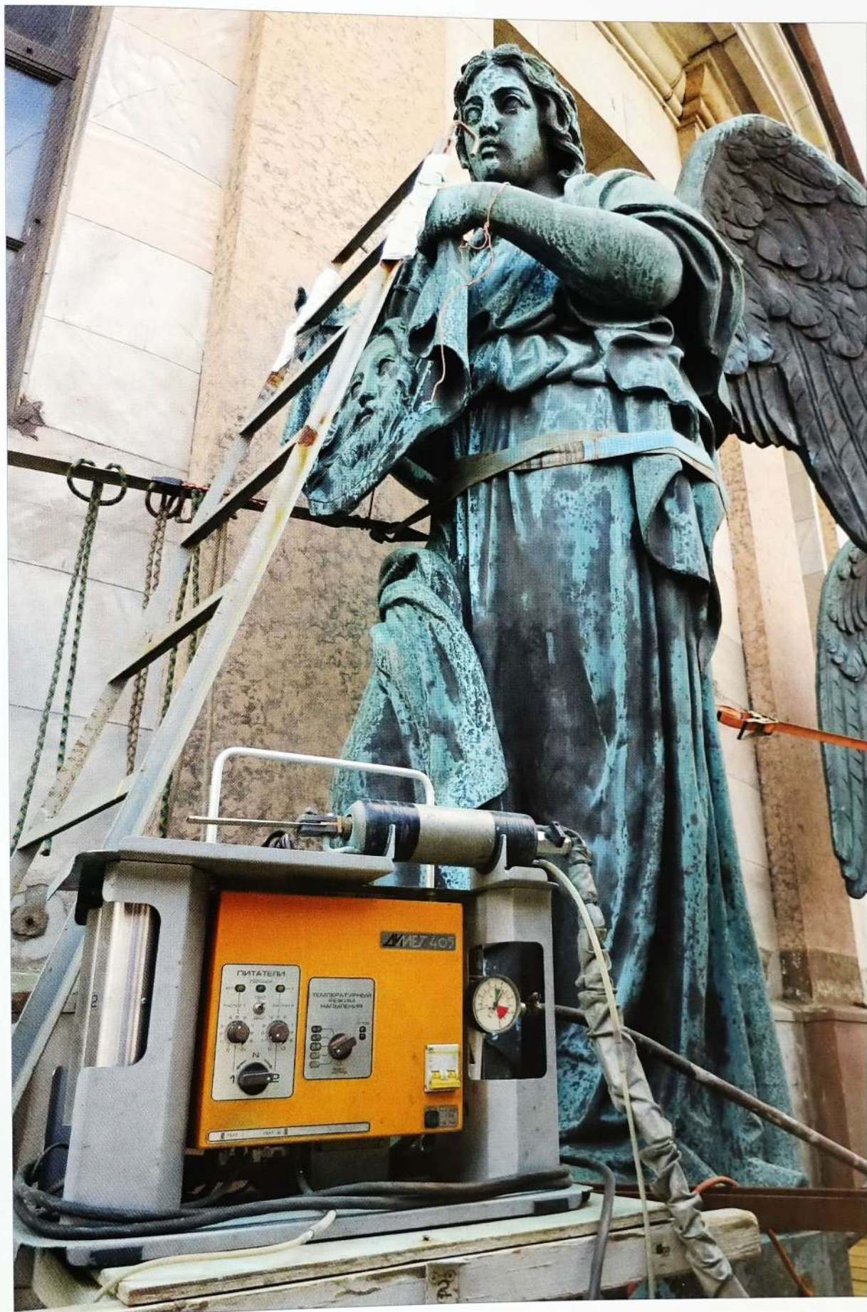
Скульптура «Ангел с нерукотворным образом» и аппарат для холодного газодинамического напыления. Фотография П.Г. Щедрина. 2015
