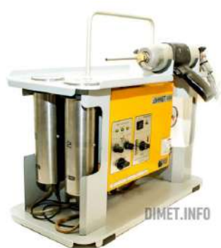
Рисунок 1 – внешний вид (а) и принципиальная схема работы (б) установки газодинамического напыления.
