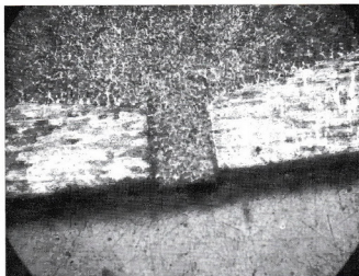
Рис. 3. Микроструктура образца из алюминиевого сплава AMg6 с искусственной микротрещиной и напылением на нее герметизирующим композитным покрытием Al-SiC ( \times 200 )
