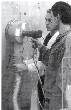
Рис. 7. Процесс нанесения герметизирующего покрытия на микротечь в сварном соединении топливного бака разгонного блока ракеты-носителя
