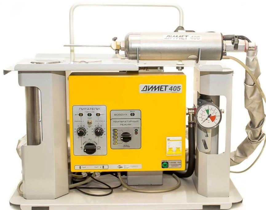
Рисунок 1 - Установка холодного газодинамического напыления «Димет – 405»
