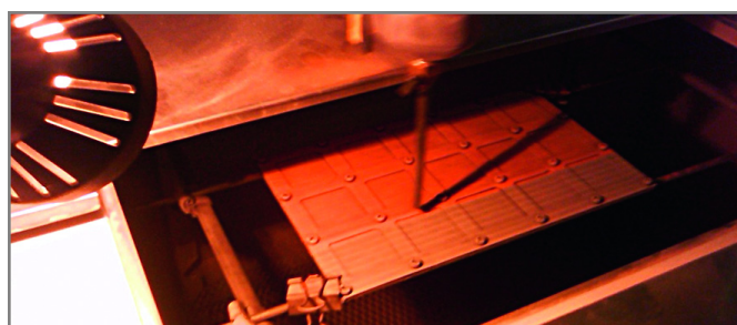
Рис. 3. Иллюстрация процесса нанесения меди на алюминиевый подслей с помощью оборудования ДИМЕТ
