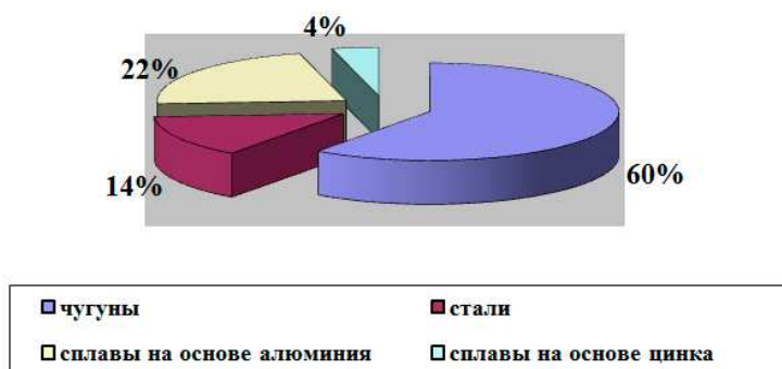
Рис. 1. Материал изготовления основных корпусных деталей военной автомобильной техники
