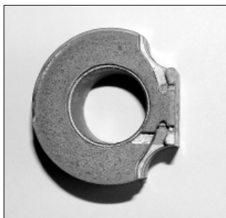
Рис. 3. Втулка шестеренного гидромотора REXROTH привода вентилятора пневматической сеялки Primera DMC-9000, восстановленная и упрочненная с использованием разработанной комбинированной технологии
