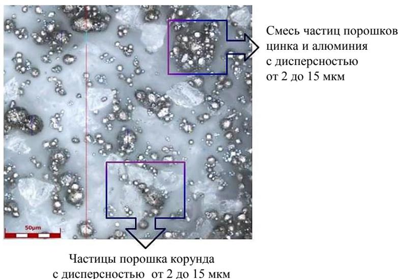
Рис. 1. Порошковый материал для напыления покрытий методом холодного газодинамического напыления
