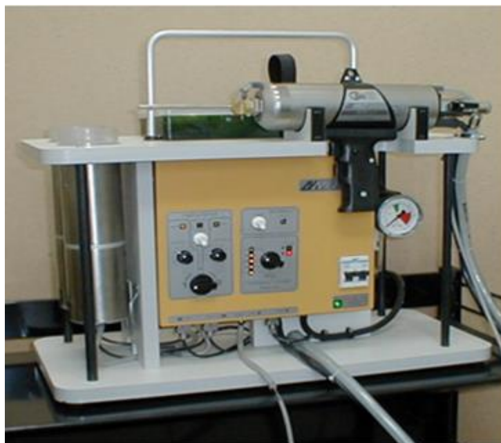
Рис. 2 - Оборудование ДИМЕТ-403К для нанесения газодинамических покрытий
