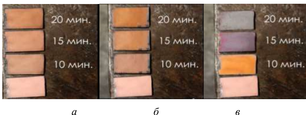
Рисунок 12 — Градации изменения цвета: а — при температуре 150°С, б — при температуре 175°С, в — при температуре 200°С
