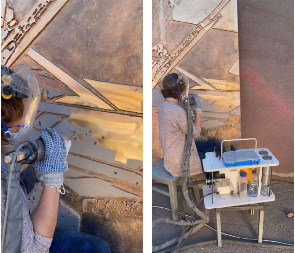
Рисунок 43 — Напыление слоя никеля на бронзовые литые барельефы.
