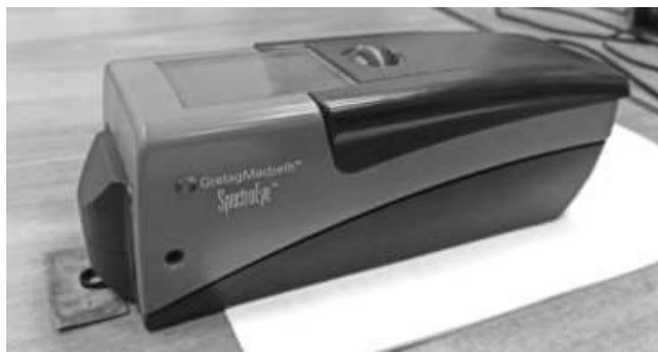
Рисунок 14 — Спектрофотометр Gretag Macbeth Spectroeye, Швейцария
