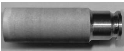
Рисунок 2 – Общий вид восстановленного плунжера гомогенизатора
