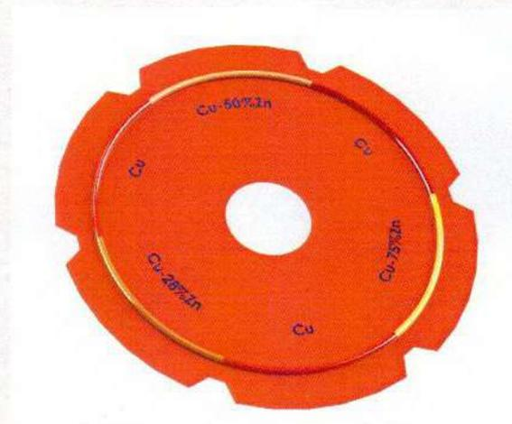
Рис. 2. Кольцо из медной проволоки с восстановленными дугами для испытаний на износ с токобъемом
