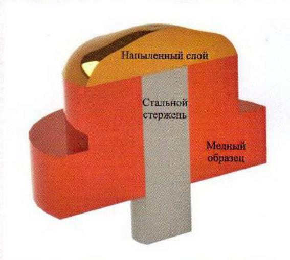
Рис. 1. Проба для определения прочности сцепления напыленного слоя с подложкой
