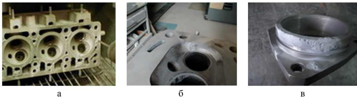
Рис. 4. Ремонт корпусных деталей способом холодного газодинамического напыления: а – головка блока; б – седло клапана; в – фланец
