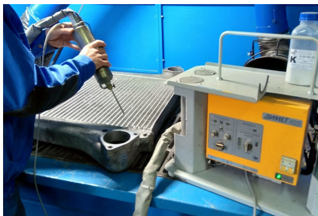
Рис. 3. Ремонт радиатора способом холодного газодинамического напыления
