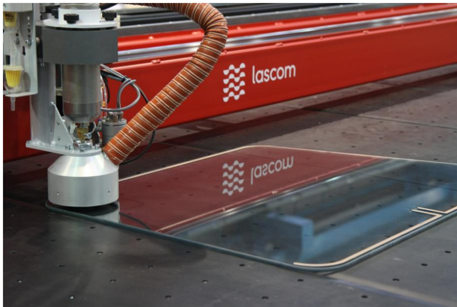
Рис.26. Нанесение контактных шин на электрообогревные стекла.
