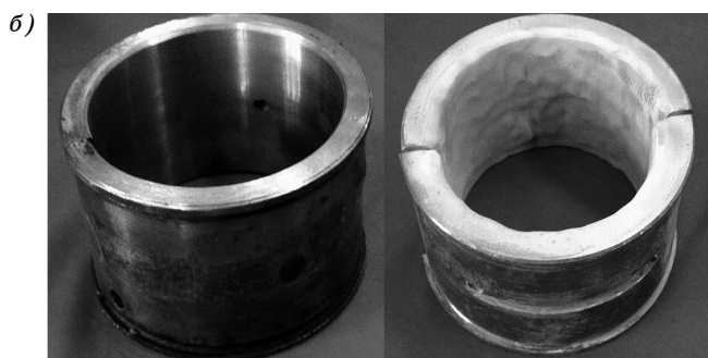
Рис. 7. Примеры ХГДН: а — райзеры для морских буровых платформ с защитным покрытием; б — антифрикционное покрытие на подшипниках скольжения для морской техники
