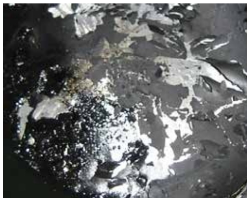
Рис. 13. Нагарообразование на днище поршня судового двигателя 3Д6 без добавки ФОРУМ® в масле (а) и с добавкой ФОРУМ® (б)
