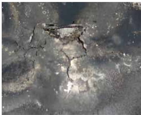
Рис. 13. Нагарообразование на днище поршня судового двигателя 3Д6 без добавки ФОРУМ® в масле (а) и с добавкой ФОРУМ® (б)
