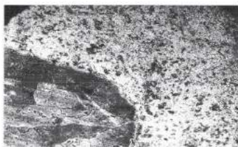
Рис. 6. Микроструктура границы раздела герметизирующего композиционного покрытия Al-SiC и подложки из алюминиевого сплава ( \sim 850 )
