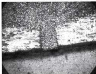
Рис. 3. Микроструктура образца из алюминиевого сплава АМг6 с искусственной микротрещиной и напыленным на нее герметизирующим композитным покрытием Al-SiC ( \times 200 )
