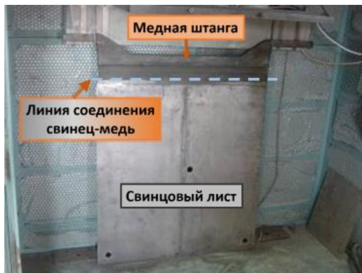
Рисунок 6.18 Пластина свинцового анода, соединенная методом ХГДН с медной штангой
