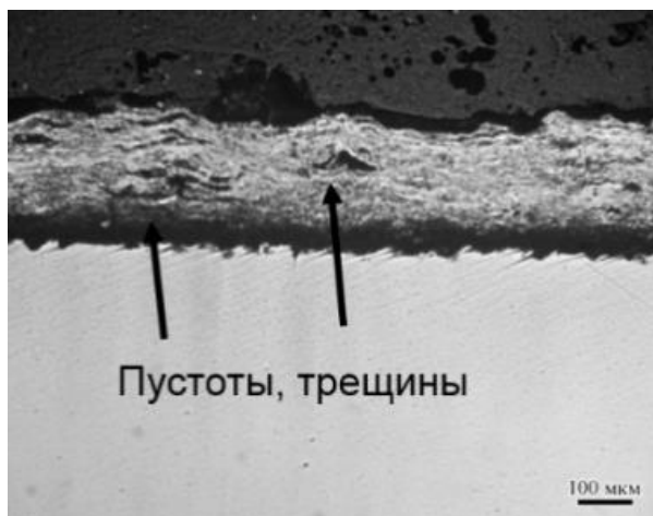
Рисунок 5.1. Поперечное сечение покрытия МЛ9, полученное при режиме напыления со скоростью 580 м/с и температуре потока 360°C
