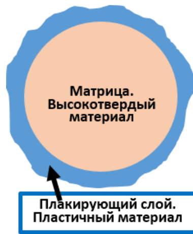
Рисунок 1.10. Схематическая структура лакированного порошка с высокотвердым ядром
