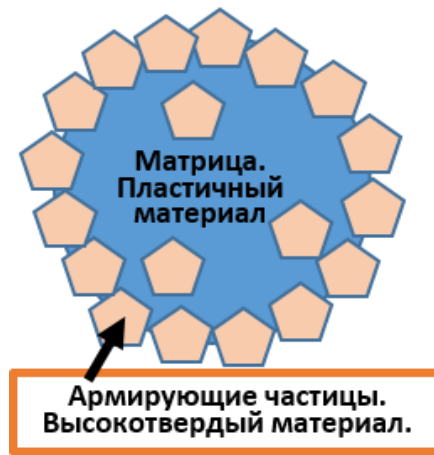
Рисунок 1.13. Схематическая структура армированного порошка
