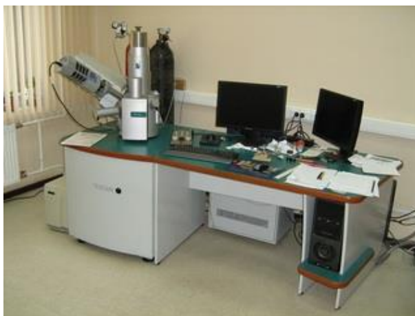
Рисунок 2.9. Растровый электронный микроскоп Tescan Vega с встроенным энергодисперсионным микроанализатором Inca X-Max
