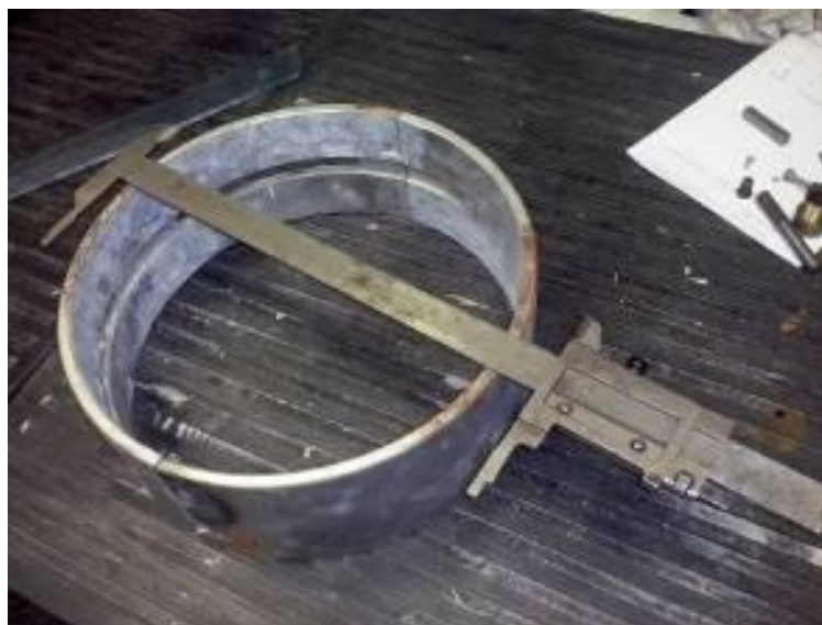
Рисунок 6.13. Подшипник скольжения, требующий восстановления
