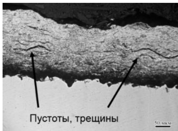
Рисунок 5.3. Поперечное сечение покрытия С9, полученное при режиме напыления со скоростью 580 м/с и температуре потока 360°С
