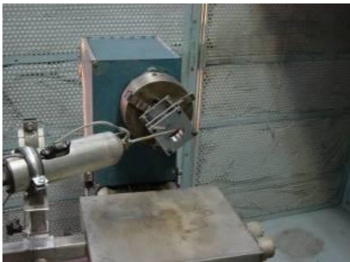
Рисунок 6.2. Процесс напыления на шатунный подшипник
