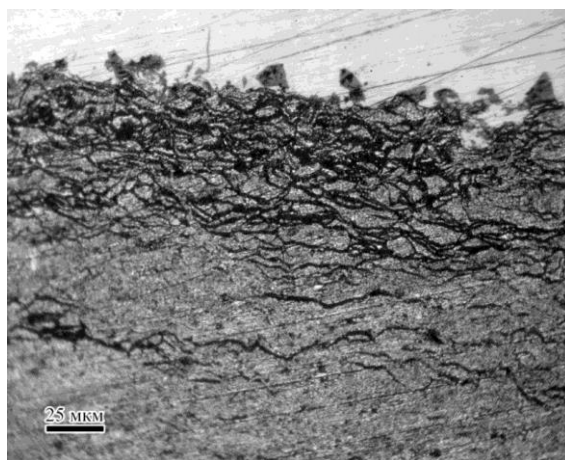
Рисунок 5.2. Поперечное сечение покрытия МСП9, полученное при режиме напыления со скоростью 580 м/с и температуре потока 360°C
