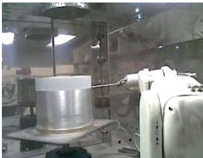
Рисунок 2.6. Автоматизированный процесс напыления покрытия с использованием робота манипулятора Kawasaki-FS003
