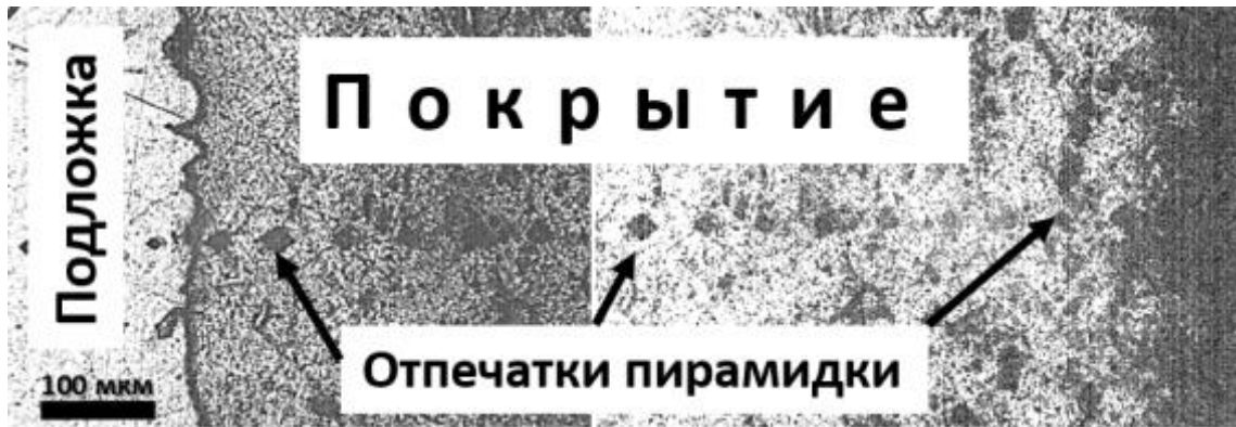
Рисунок 5.26. Следы отпечатков пирамидки при определении микротвердости
