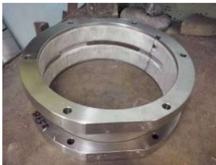
Рисунок 6.14. Вкладыши подшипника в оснастке после напыления
