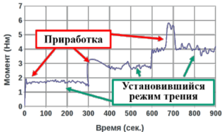
Рисунок 5.29. Изменение момента трения от времени испытания покрытия C9I70
