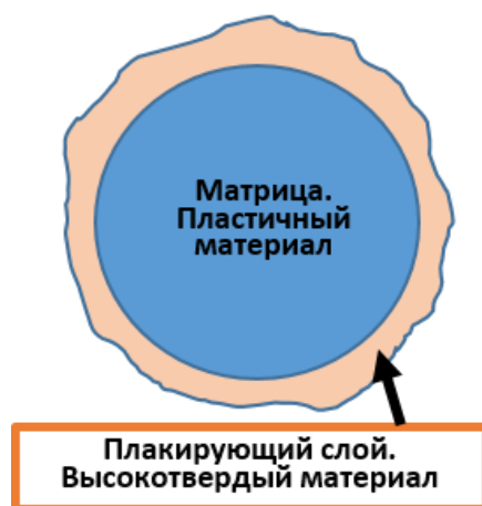
Рисунок 1.9. Схематическая структура плакированного порошка с пластичным ядром
